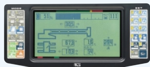
■画面が任意に切替えられ、「作業範囲制限機能とボイスアラーム（音声警報装置）」の付いた最先端「マルチビジョン」を装備したACSコンピュータロード。
